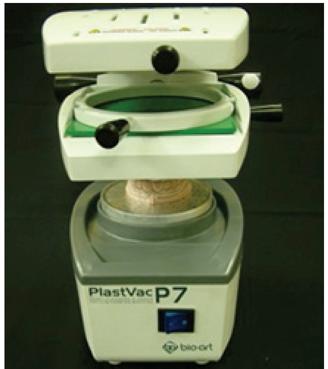
Figura 3: Posicionamento do modelo de gesso devidamente preparado na máquina de termoformagem à vácuo.
